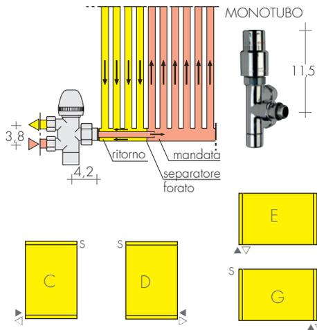
La valvola cromata monotubo Brem  $\varnothing 1/2"$ , con sonda  $\varnothing 10$  mm, può essere usata nella versione termostatica o manuale ed è dotata di deviatore di flusso per invertire mandata e ritorno.
