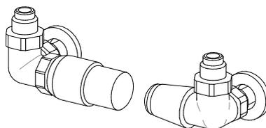
KIT ROBINETS TON COMMANDE LATÉRALE avec tête THERMOSTATIQUE Art. KTL 177,10€
