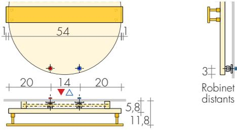
Sur demande raccords verticaux EG ▲▼ 14 cm, avec manchon et vannes visibles.
