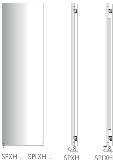
MODELE SPLXH panneau vertical avec lamelles chauffantes à l'arrière
